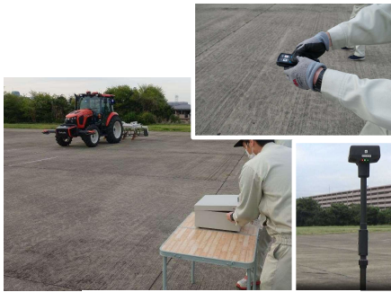
GNSS・リモコン通信障害確認試験
