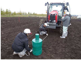
人・障害物検出機能確認試験
